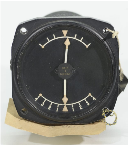
Früher britischer Turn & Bank Indicator von Reid & Sigrist (gegr. 1928). Es war gar nicht so einfach, nur nach diesem Instrument in den Wolken zu fliegen. Eine spätere Version dieses Geräts war u.a. in der Spitfire verbaut.
