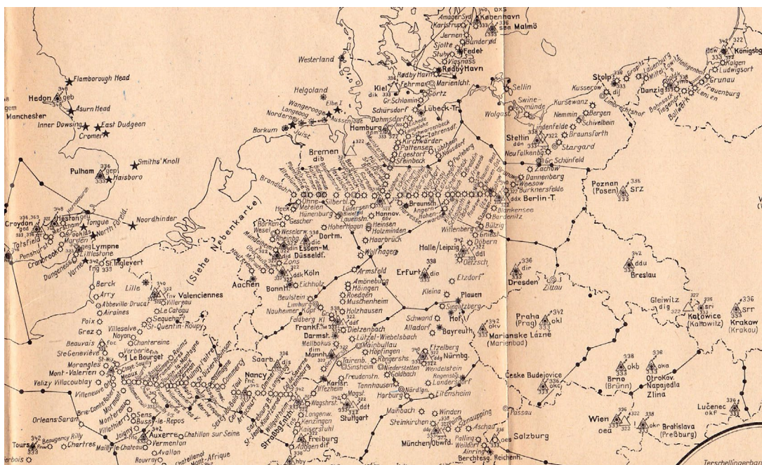
Hauptstreckenfeuer und befeuerte Flughäfen in Europa 1936. Ketten von Leuchttürmen für Nachtflieger verbanden die Metropolen Europas. So ähnlich wurde auch die Transkontinentalstrecke quer durch die USA für Sichtflüge bei Nacht befeuert. (Die durchgezogenen Linien sind die Grenzen der Flugsicherungsbezirke.)
