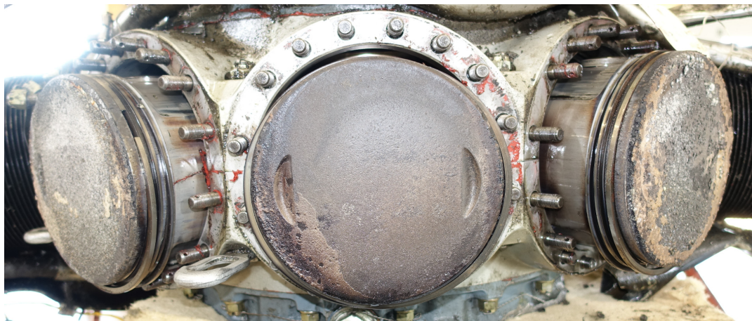
Abbildung 15: Zylinderpositionen 1, 2 und 3 des linken Motors mit Kolben.
